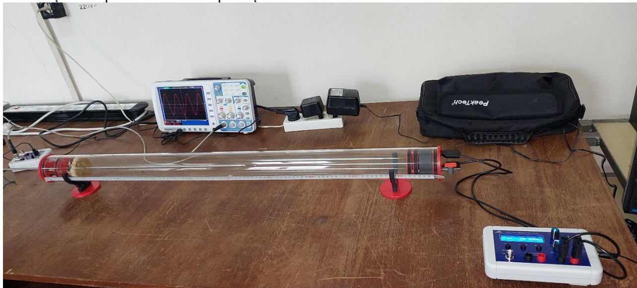
Fig. 3 - Setarea experimentală cu tub Kundt
